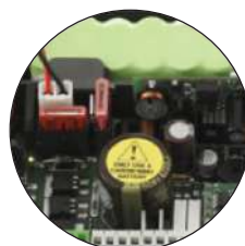
BATTERIE DI EMERGENZA NELLE VERSIONI CC242ETOPCB e CC242EXTOPCB
