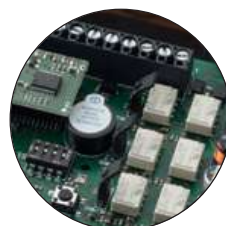
UNITÀ FISSA, GESTIONE USCITE DI SICUREZZA (NC/8,2kΩ)
