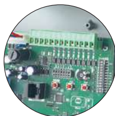
INGRESSI OPTOISOLATI CON SEGNALAZIONE A LED
