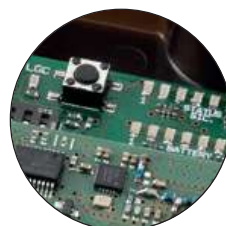
8 LED ROSSI STATO SICUREZZA 8 LED VERDI LIVELLO CARICA- BATTERIA
