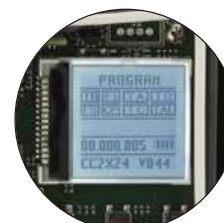
AUTOPROGRAMMABILE TRAMITE DISPLAY LCD GRAFICO PER HL2524ESB-HL1824ESB
