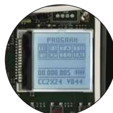
AUTOPROGRAMMABILE TRAMITE DISPLAY LCD GRAFICO BL1924ASW
