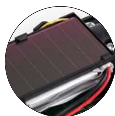
FUNZIONAMENTO COMBINATO BATTERIA - PANNELLO SOLARE SUL TRASMETTITORE
