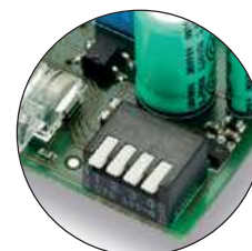
DIP SELEZIONE LIVELLO DI SENSIBILITÀ
