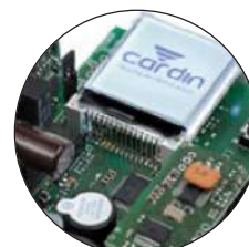
AUTOPROGRAMMABILE TRAMITE DISPLAY LCD GRAFICO
